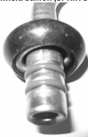
Пружинный замок (SPRINGLOCK)
