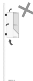
Рисунок 3.3: Блоки в корпусах, кроме А2 и А3, не следует монтировать так, как показано – без задней панели. При этом охлаждение будет недостаточным, что может резко сократить срок службы.
