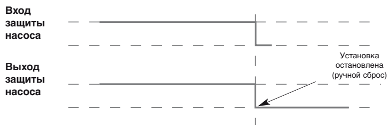
Рис. 7 - Защита одиночного насоса
