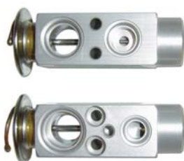
DT07 DETENDEURS BLOC STANDART - 2 TON A BRIDE entrée HP: 3/8" sortie HP: 1/2" entrée BP: 5/8" sortie BP: 3/4"
