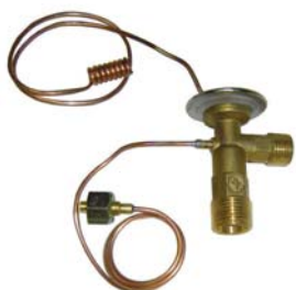
DT03 DETENDEURS O'ring égalisation - 2 TON entrée : 3/8" O'Ring sortie : 1/2" O'Ring bulbe long égalisation 1/4" O'Ring femelle
