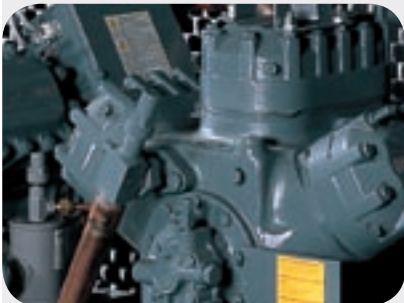
Rubinetti per poter isolare ogni singolo elemento del circuito. Taps for isolating every single element in the circuit. Robinets pour pouvoir isoler chaque élément simple du circuit. Hähne zum Isolieren jeder Elemente des Kreislaufes. Grifos para poder aislar cada elemento del elemento del circuito. Отсекающие вентили для изоляции каждого
