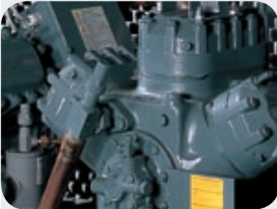
Rubinetti per poter isolare ogni singolo elemento del circuito. Taps for isolating every single element in the circuit. Robinets pour pouvoir isoler chaque élément simple du circuit. Hähne zum Isolieren jeder Elemente des Kreislaufes. Grifos para poder aislar cada elemento del elemento del circuito. Отсекающие вентили для изоляции каждого отдельного элемента контура.
