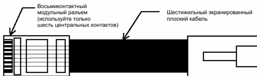
Рис. 25 Шестижильный кабель Hiobus с восьмиполюсным разъемом (1 и 8 контакты не подсоединены) для соединений Microface ~/=24В. Кабель должен быть экранирован.
