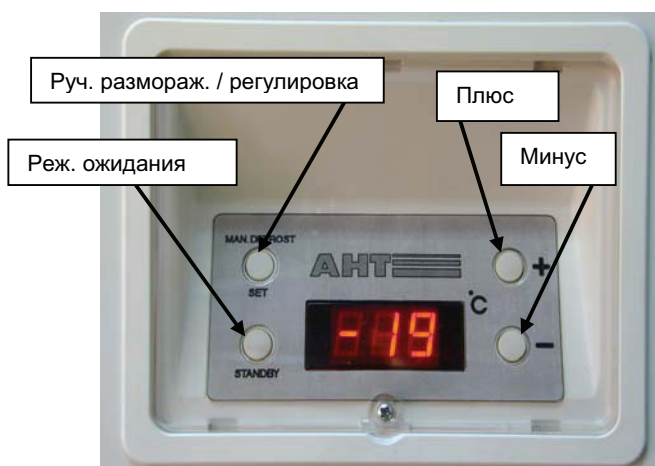
Изображение АНТ 601 (°C); АНТ 701 выглядит так же, кроме индикатора температуры (в °F)
