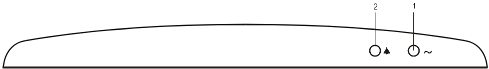
Выносной пульт индикации (ВПИ) холодильника ДХ-241-6:
