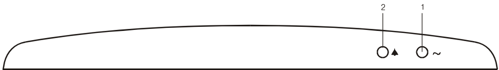
Выносной пульт индикации (ВПИ) холодильника ДХ-244-6:
