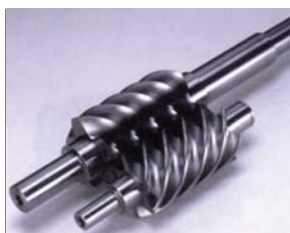
Рис.1 Ведущий и ведомый винтовые роторы двухвинтового компрессора
