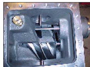
Рис 8 Доступ к ротору через инспекционное окно
