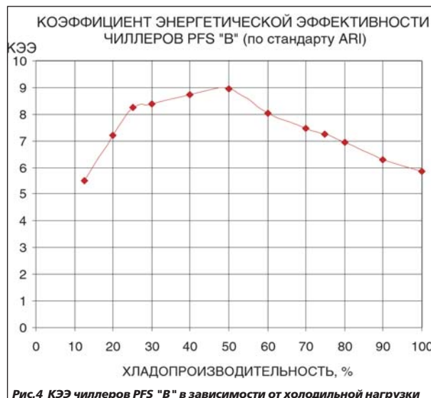
Рис.4 КЭЭ чиллеров PFS "B" в зависимости от холодильной нагрузки
