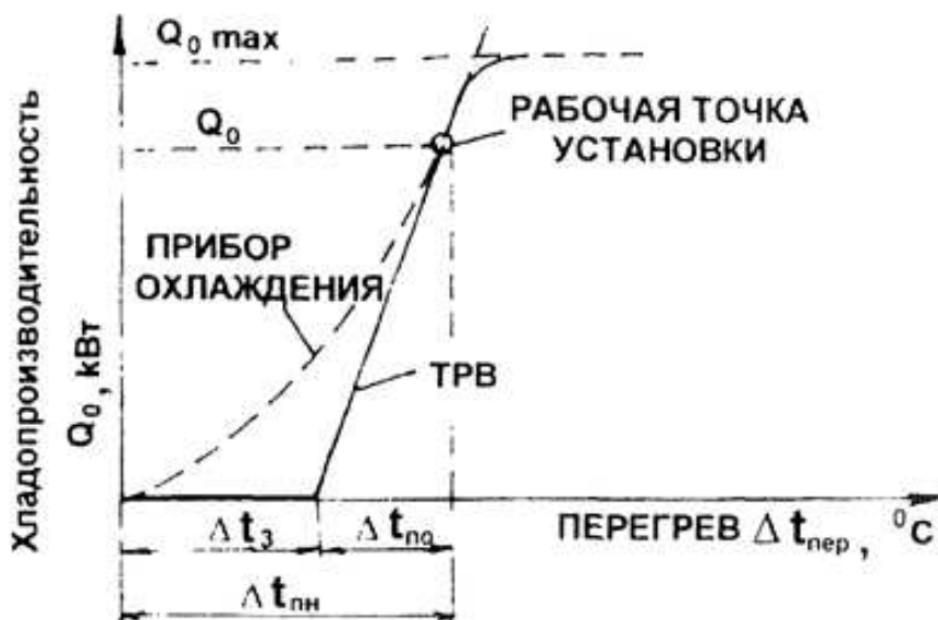
Рис. 1. Кривые рабочих характеристик регулятора и испарителя для случая регулирования подачи хладагента в испаритель с помощью ТРВ.
