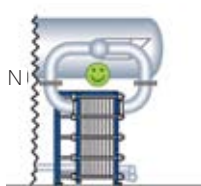
Конструкция с двумя симметричными выходами, соединяющимися перед входом в сепаратор, является, вероятно, более дорогой по сравнению с (M).
