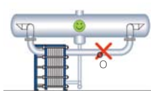
Избегайте использования асимметричных возвратных линий (O). Применение длинного и узкого сепаратора обойдется дешевле по сравнению с конструкцией типа (L); это будет способствовать ламинарному течению, что повысит эффективность.
