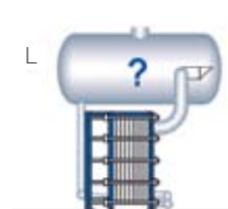
Применение сепаратора (L) относительно большого размера по ширине и малого по длине обойдется дорого, а эффективность сепарации остается под вопросом. См. также (O).
