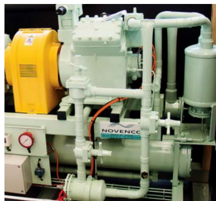
Системы кондиционирования воздуха и охлаждения Novenco теперь оснащаются конденсаторами Альфа Лаваль для поддержания низкой температуры продуктов во время длительного морского плавания.
