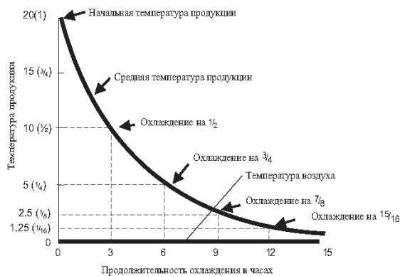
Рис. 10. Типичная температурная кривая охлаждения продукции. Цифры в скобках показывают результат деления разности температур продукта и воздуха в охлаждаителе на текущий момент на разность температур неохлажденного продукта и воздуха.
