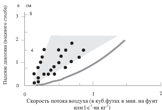
Рис. 15. Падение давления в зависимости от скорости воздушного потока, проходящего через палеты с грушами сорта Бартлетт. Кривая на графике соответствует типичному потоку воздуха при охлаждении почти сферического продукта, упакованного в коробки, где площадь вентиляционных отверстий составляет 5% боковых стенок, без использования дополнительных внутренних упаковочных материалов и без каналов байпаса воздуха. Высокая потребность в давлении возникает на тех коробках, где вентиляция недостаточна либо где фрукты дополнительно завернуты в бумагу.
